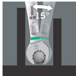
Gracias a la geometría especial de la boca, orientada a 7,5° y de doble hexágono, la llave de doble boca Joker 6005 es capaz de duplicar las posibilidades de posicionamiento al girarla reiteradamente en 180° por su eje longitudinal. Así, cada 15° es posible apretar la tuerca o la cabeza del tornillo. La Joker
